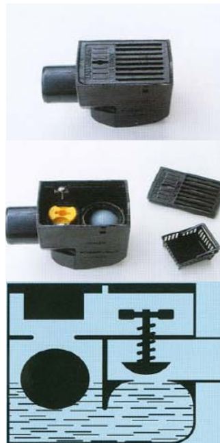
Beispiel eines Rückstauverschlusses mit Schwimmer:
