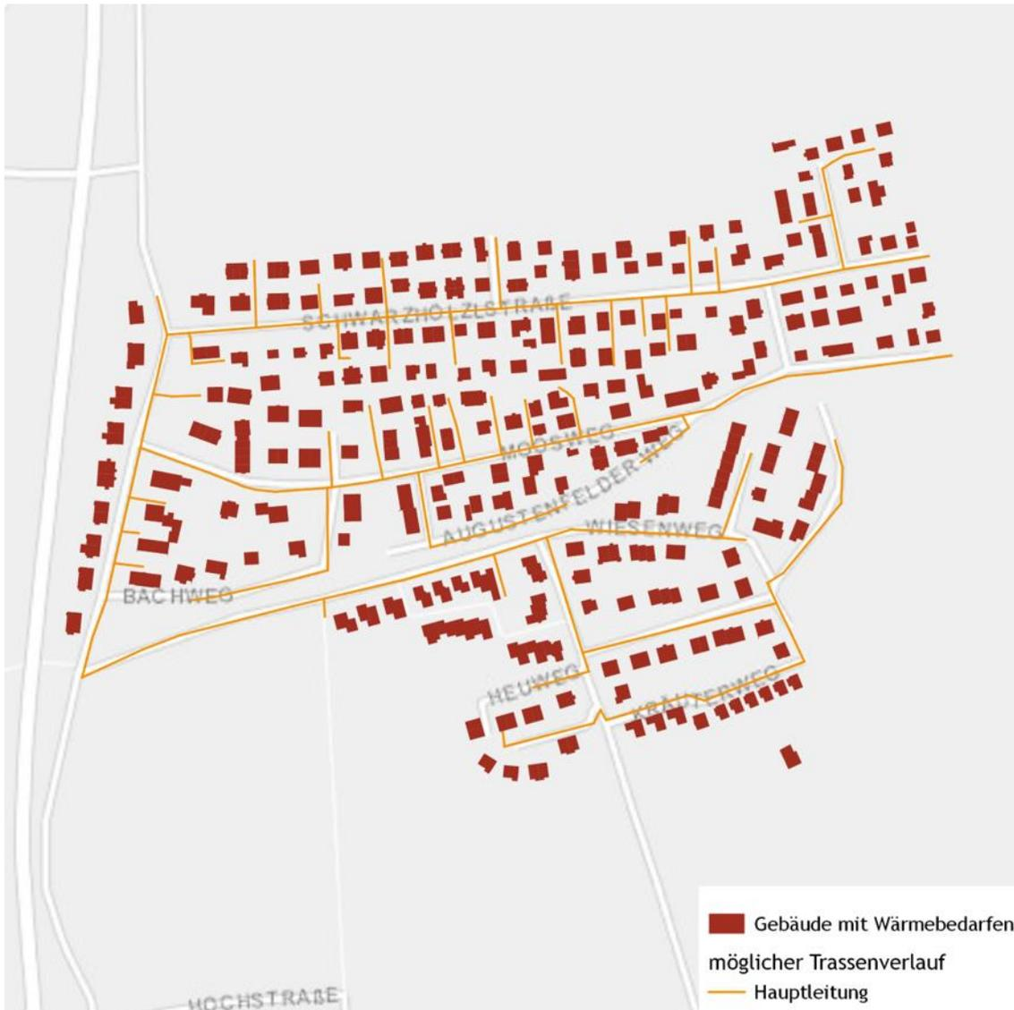
Abbildung 20: Visualisierung vorhandener Wärmeabnehmer und beispielhafter Trassenverlauf (Quelle: INEV)
