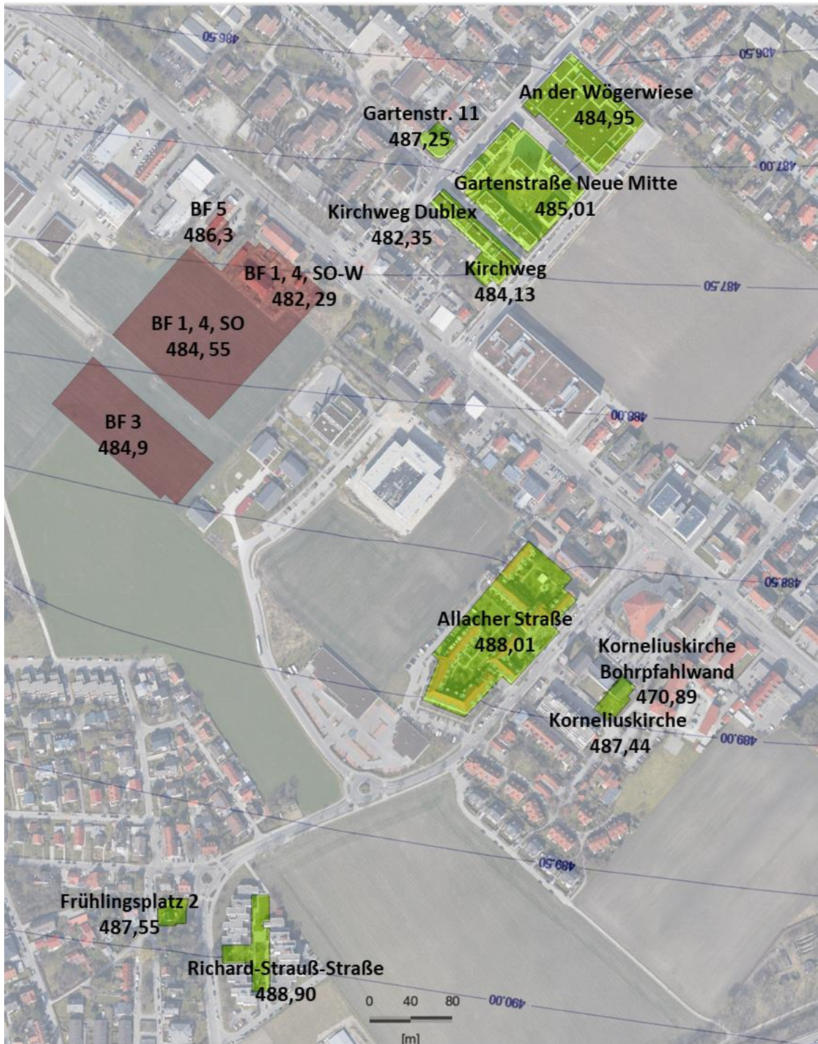
Abbildung 3-3: Übersichtskarte zu den Bestandstiefgaragen sowie den geplanten Untergrundverbauungen im Anna-Quartier, Angaben in [m NN].
