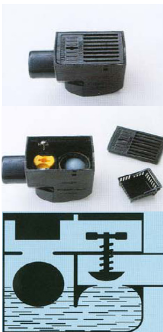
Beispiel eines Rückstauverschlusses mit Schwimmer:
