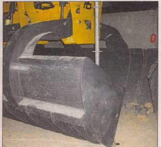
Greifer für Biomassetransport im Bunker, Fassungsvermögen circa 2 m 3 .
